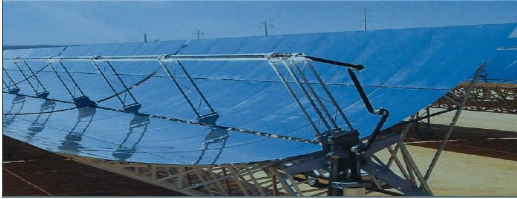
**Figure II.3** :capture cylindro-parabolique
