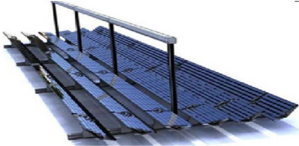
**Figure II.4** : capture solaire type Fresnel
