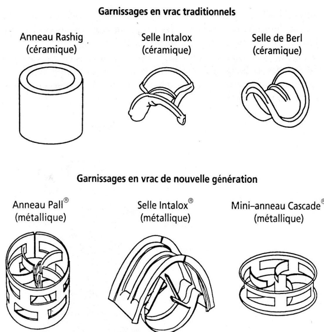
Figure I-13: Exemples de garnissage en vrac
