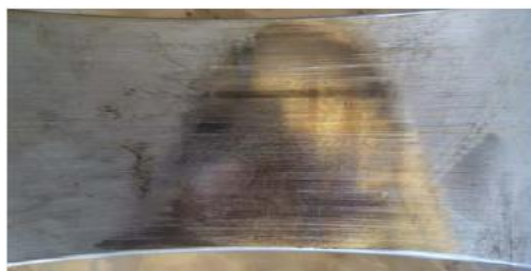
Fig. (IV-3) : Une usure avec strie de moyenne taille
