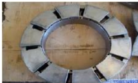
Fig. (IV-8) : Traces d'usures importantes sur les patins
