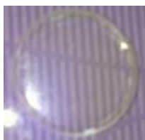
Figure 2.4 : Réseau de copolymère synthétisé par photo polymérisation (pastille)
