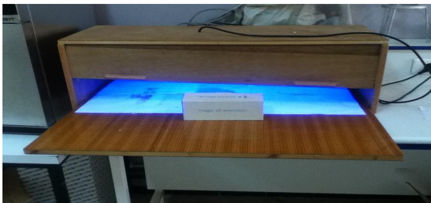
Figure 2.2 : Dispositif de photo-polymérisation UV
