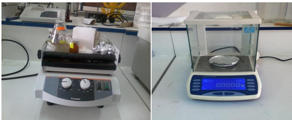
Figure 2.3 : Agitateur mécanique (à gauche) et balance de précision (à droite)
