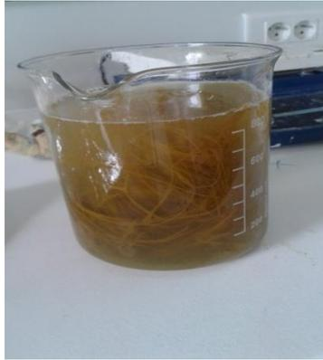
*Fig.III.9 :l'alfa dans un bécher pour lavage avec de l'eau distillée*
