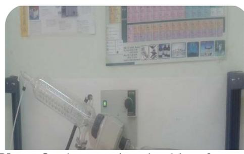
**Photo 8** : évaporation de chloroforme par le rotavapor (originale).
