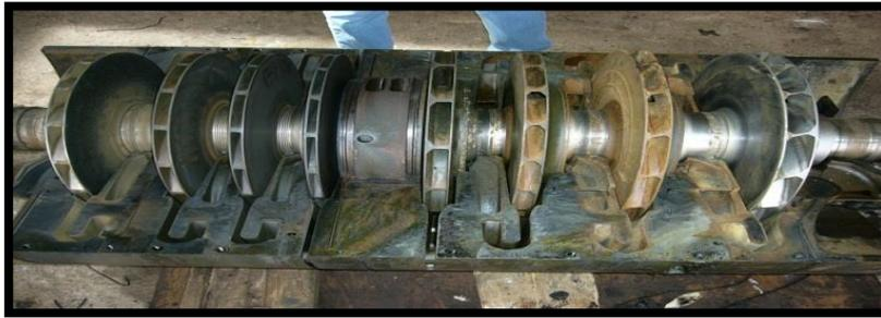
**Fig. v.5.** Boue sur rotor
