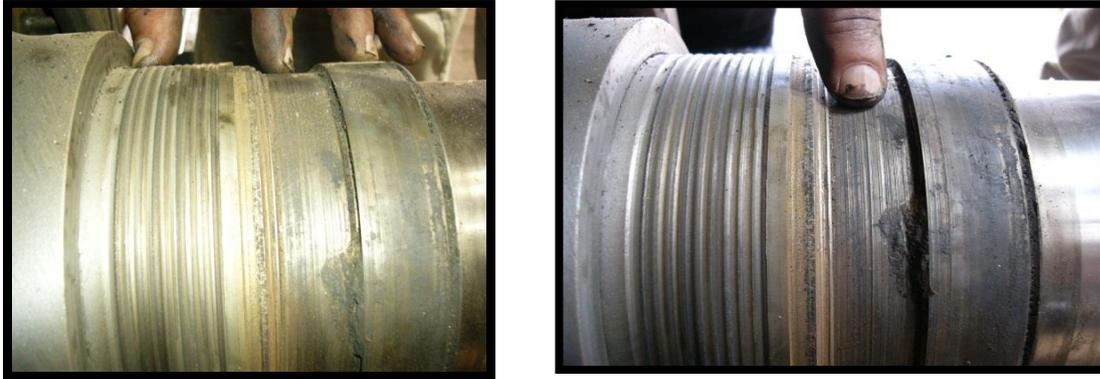
**Fig. V.3. L'érosion sur labyrinthe**
