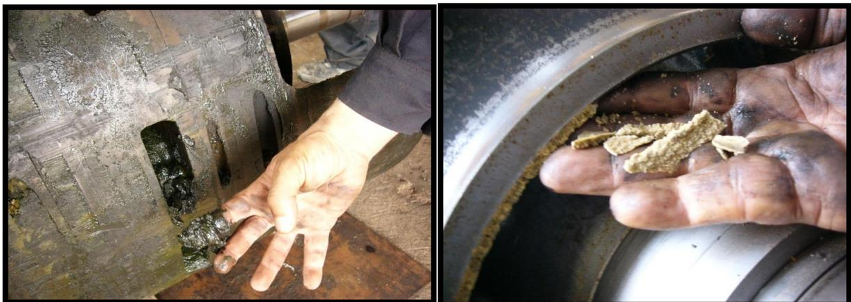
**Fig. V.2. Paraffines dans un compresseur**
