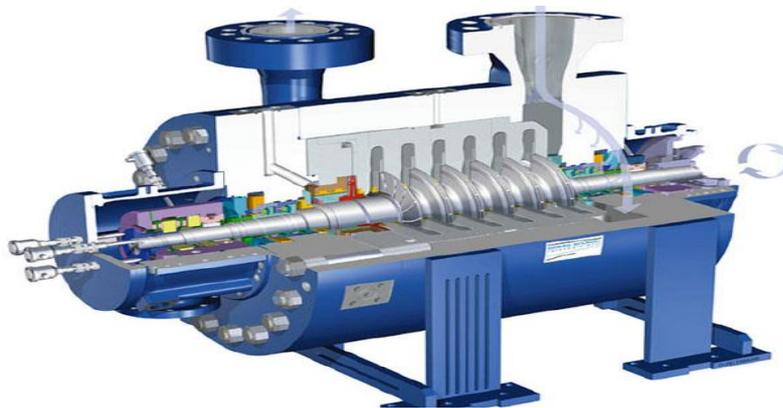
**Fig. II.8. Compresseur centrifuge**
