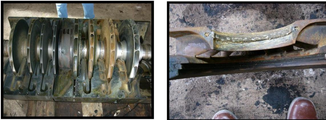
**Fig. V.4. L'érosion sur rotor**
