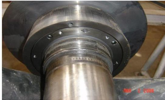
**Fig.: III.5 le piston d'équilibrage**
