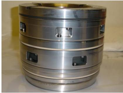
**Fig. : III.7 La garniture mécanique**
