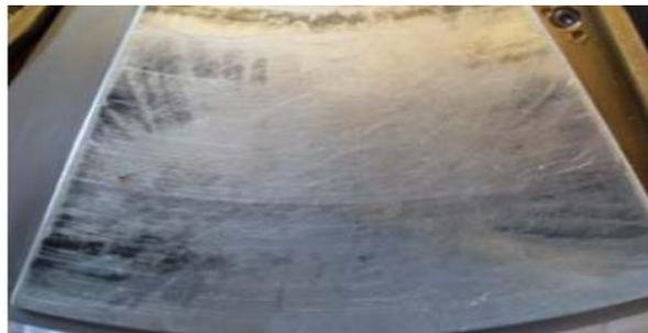
**Fig. V 6.** Usure dans un palie
