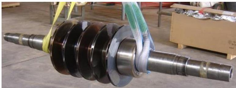
**Fig. III.3 le rotor du compresseur**
