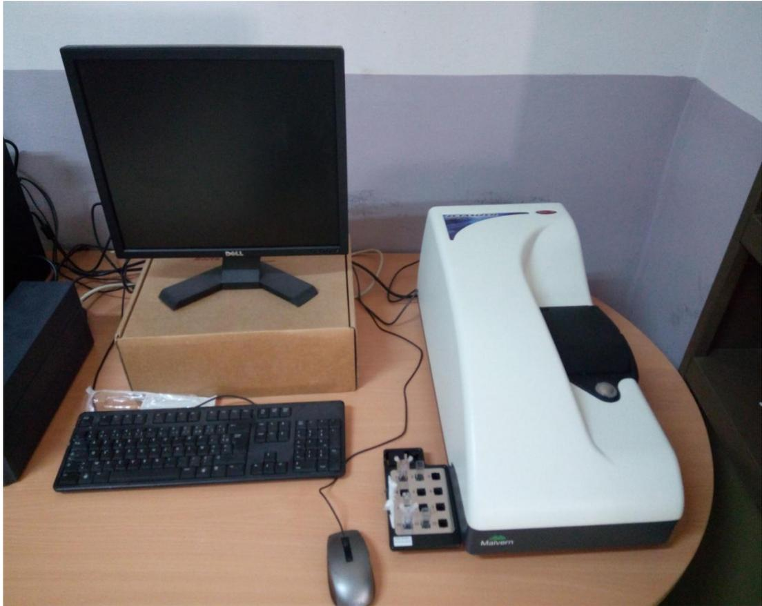
**Figure 10.** L'appareil qu'on a utilisé pour la caractérisation (Zetasiser nano ZS)
