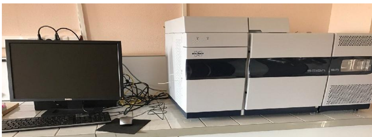
Figure 6 : Schéma d'un chromatographe en phase en gazeuse couplée à la spectrométrie de masse 8
