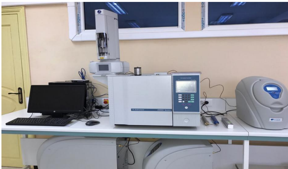
Figure 5 : L'appareil de chromatographie en phase gazeuse YL Instrument, 6500GC System Controller.
