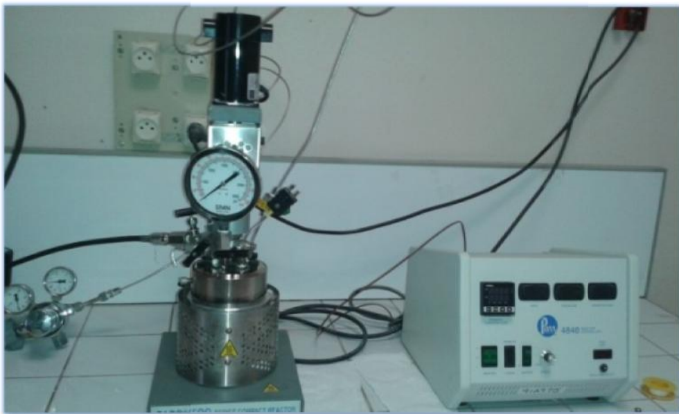
Figure 3 : Dispositif du test catalytique
