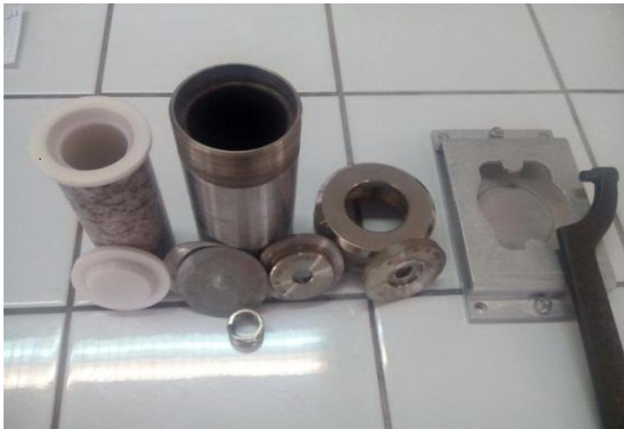
**Figure 19:** image représentant les composants de l'autoclave
