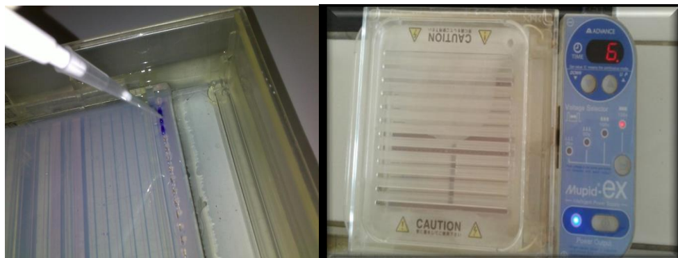
Fig II. 4 : Le dépôt des échantillons sur gel d'agarose dans la plaque a électrophorèse - Après migration, placer le gel dans l'appareil UV réuni avec caméra et prendre une photo.
