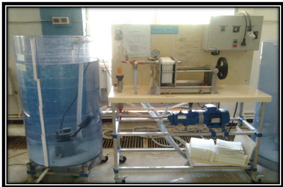
Figure IV.1 : pilote TE 500 de la filtration sur support.
