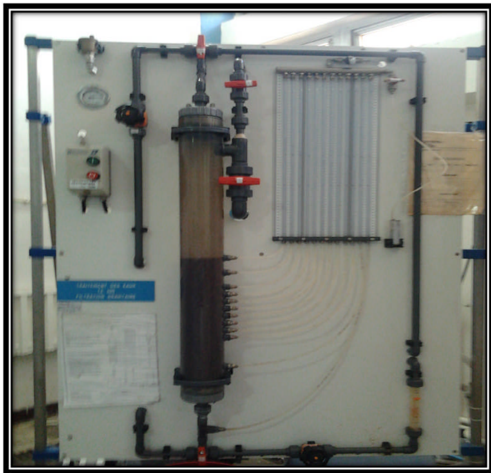
Figure IV.4 : pilote TE 400 de la filtration sur sable.
