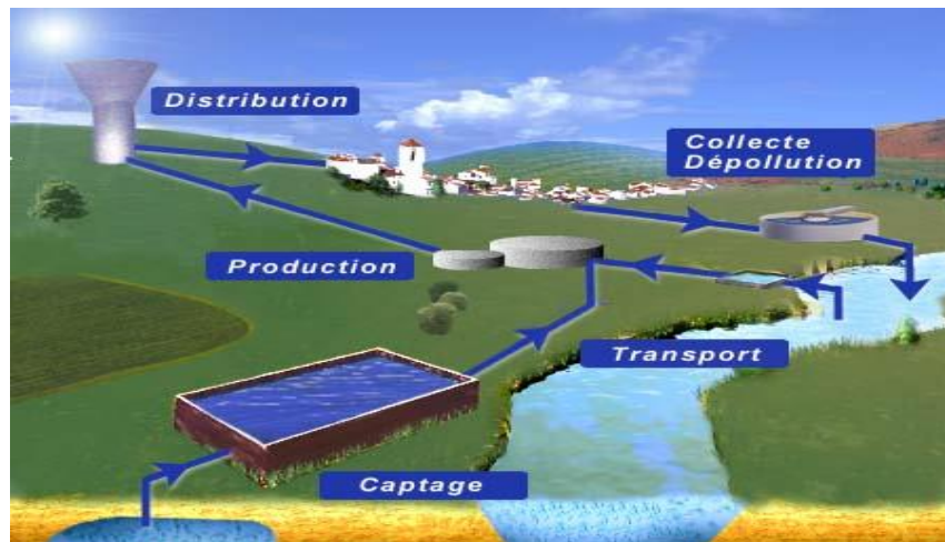
Figure I 3 : schéma générale d'alimentation en eau potable. [16]
