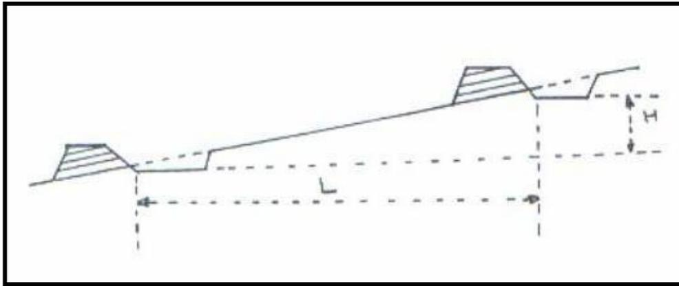
Figure 5.10 : Eléments caractéristiques d'un réseau de Banquette.
