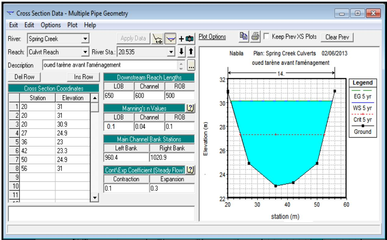
Figure 5.19: Fenêtre des données géométriques de profil n°20 (Oued Tarène)
