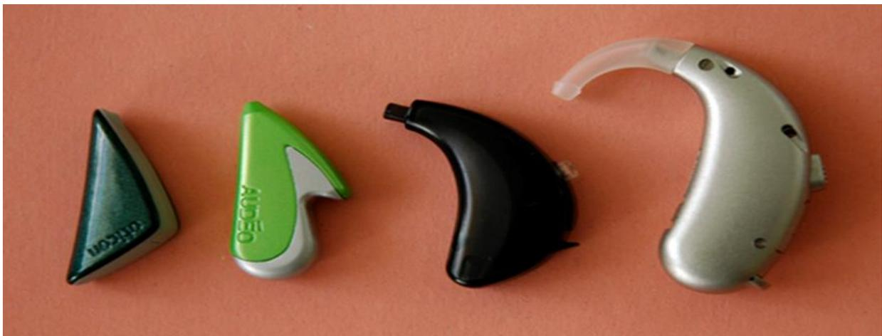
Figure 2.2: Appareils contour d'oreille
