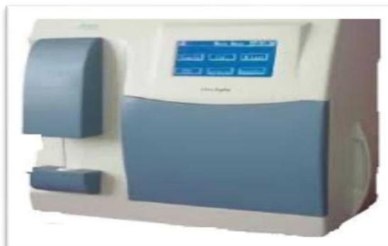
Figure 18: Ionomètre.
