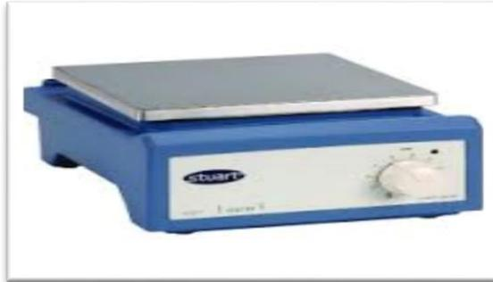
Figure 19: Agitateur magnétique.
