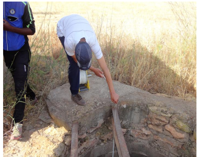
Photo 04 : mesure de niveau piézométrique (01/06/2012).
