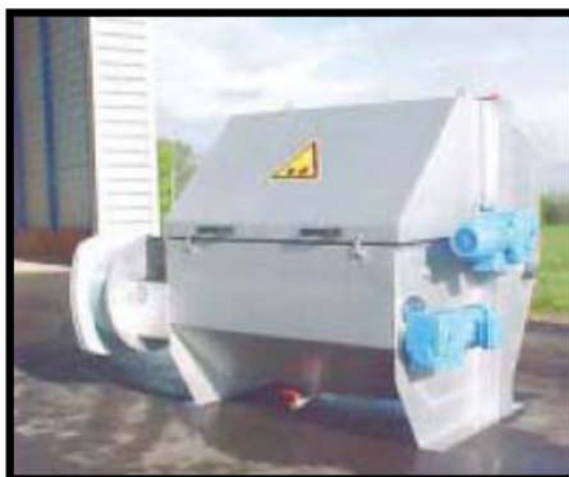
Figure N°03 : un tamisage rotatif [22].
