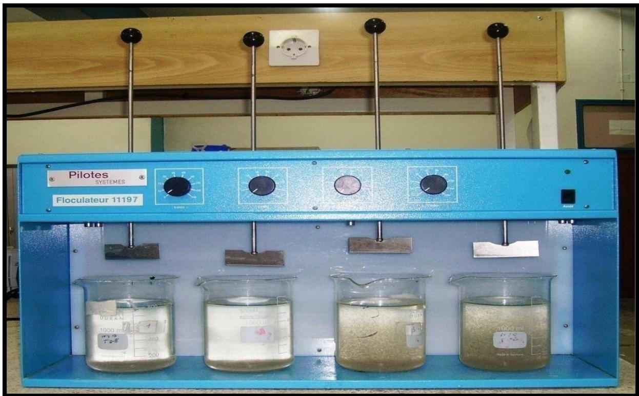
**Photos N°2 : Le Jar-test (floculateur 11197) (laboratoire du Département d'Hydraulique. Université de Tlemcen)**
