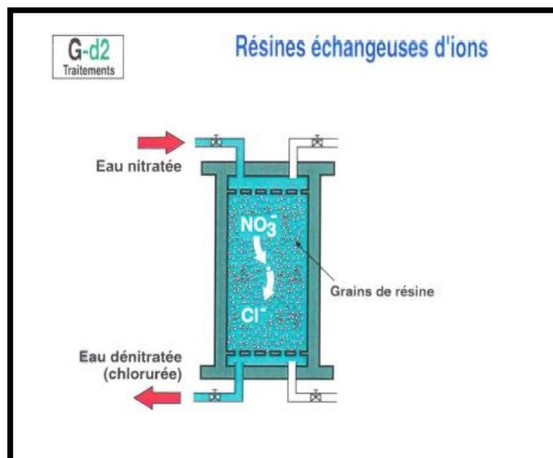
Figure N°13: La dénitratisation par résine échangeuse d'ions [40].
