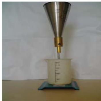
**Figure 2.2** : Essai du cône de Marsh.
