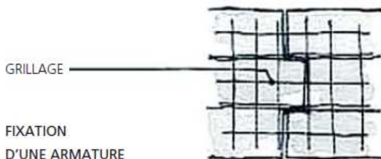
Figure 4.10 : Fixation des armatures
