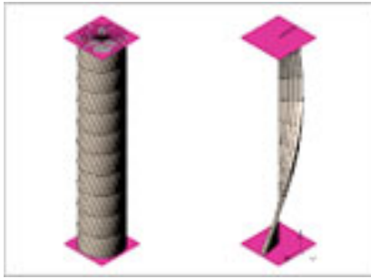
Torsion d'une poutre
