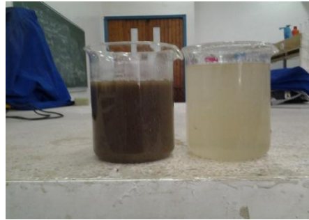
Figure III.13 : Eau à l'entrée et la sortie du décanteur lamellaire à contre-courant (position B).
