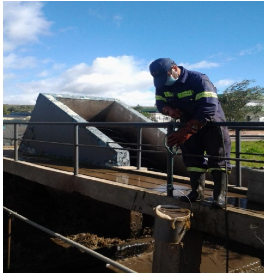
Figure III.4 : Méthode de prélèvement dans la STEP.
