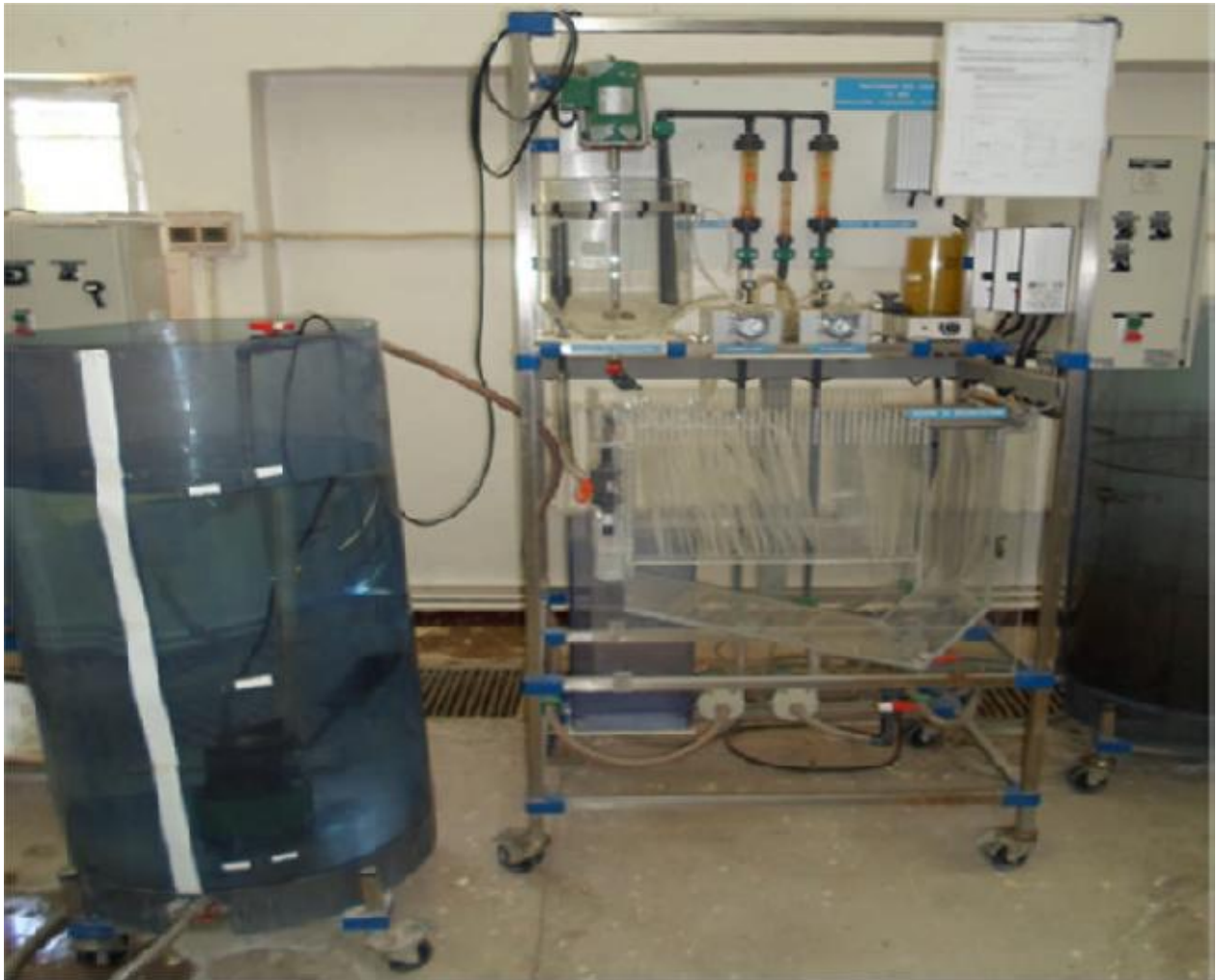
Figure III.2 : Pilote de coagulation-floculation et décantation (TE 600) (laboratoire du Département d'Hydraulique. Université de Tlemcen). [20]
