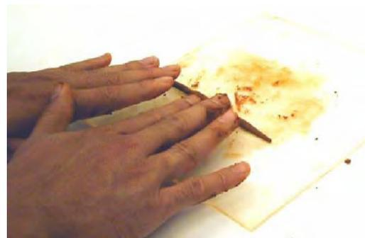
**Figure 02 :**  $W_L$  : réalisation de la rainure **Figure 03 :**  $W_p$  : réalisation du rouleau de sol
