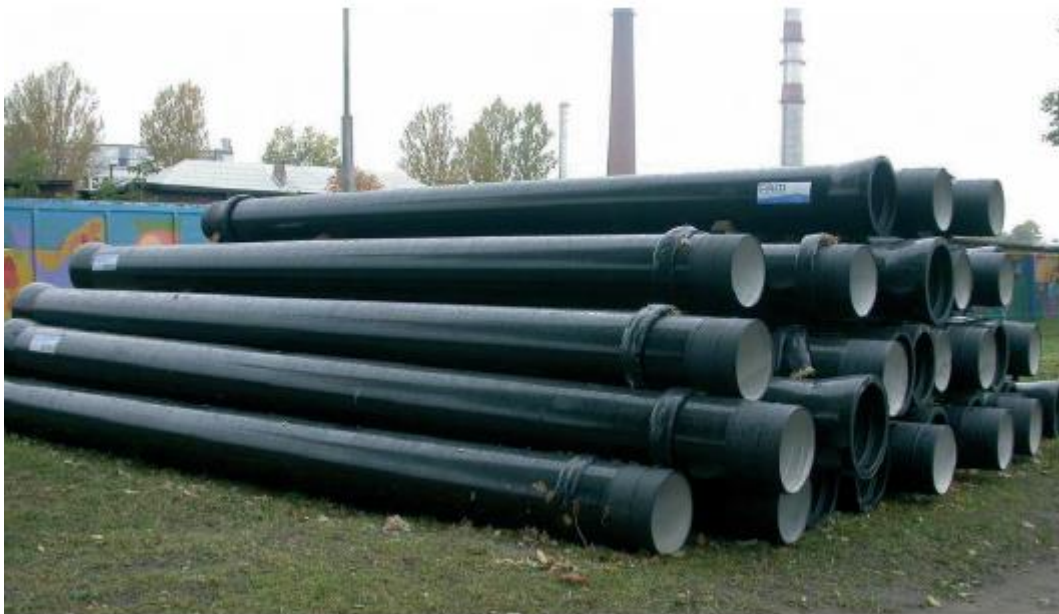
Photo I.3 Tuyaux en fonte ductile, TT DN 80 - 700
