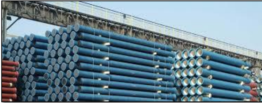
Figure I.3 : canalisation en fonte grise (Saint-Gobain, 2006)
