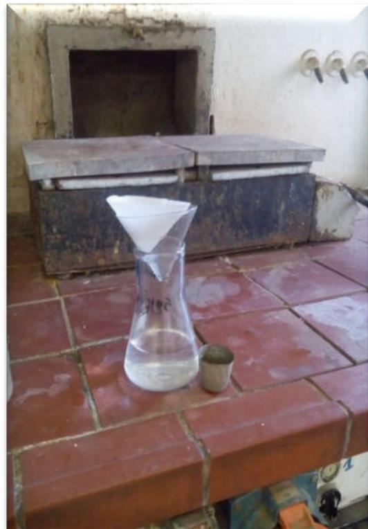
**Figures IV.46** : le filtre avec le précipité, et le creuset
