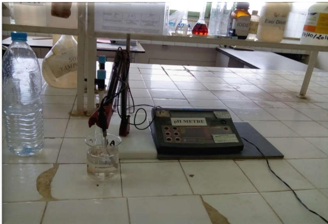
Figure IV.37: Appareil de mesure de pH et de température
