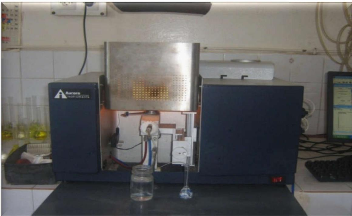
**Figure IV.36** : spectrophotomètre d'absorption atomique type Perkin Elmer
