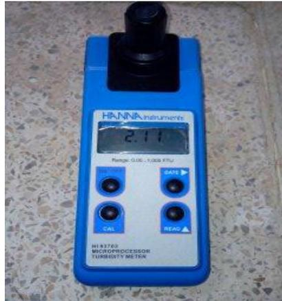
Figure V. 1: Turbidimètre
