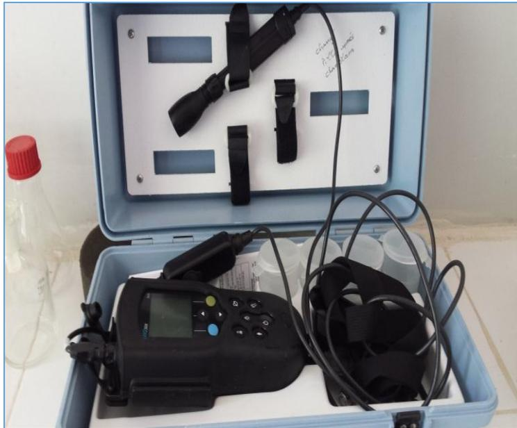
**Figure IV.9 :** Photo de l'Ultramètre HQ 30D.
