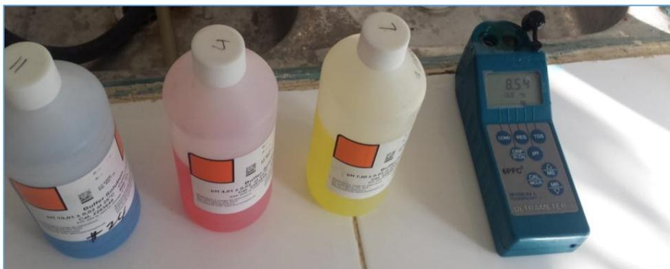
Figure IV.18 : Calibrage de l'appareil avec solution pH.
