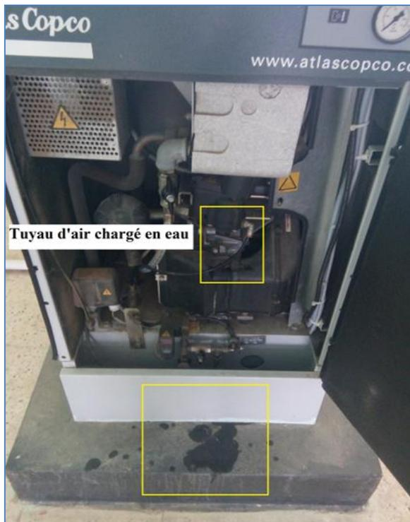
**Figure V.36 :** La photo de surpresseur d'air chargé d'eau.
