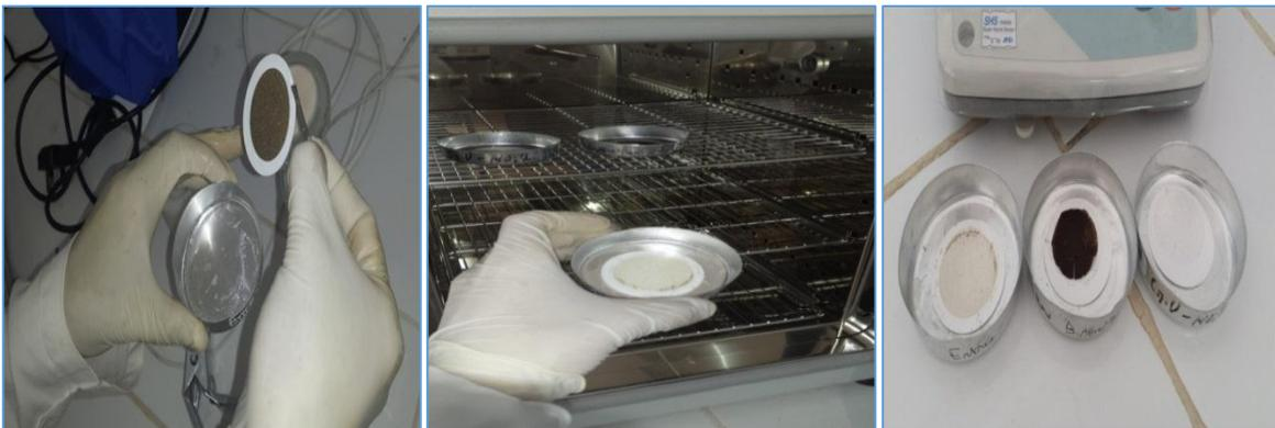
**Figure IV.15 :** Principaux étapes d'analyses de MES filtration à vide séchage et pesé (respectivement de gauche à droite).
