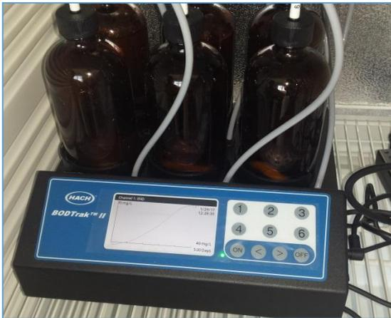
Figure IV.5: DBOmètre BODTrak II.
