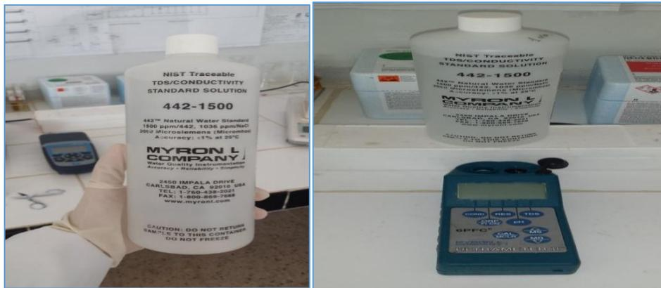
Figure IV.17 : Calibrage de l'appareil avec solution TDS.
