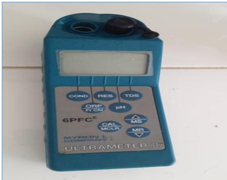
Figure IV.8 : Photo de l'Ultramètre II.
