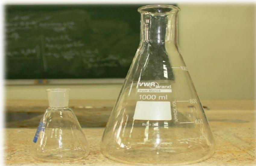
Figure IV. 6 : Différents Erlenmeyers pour la préparation des solutions.
