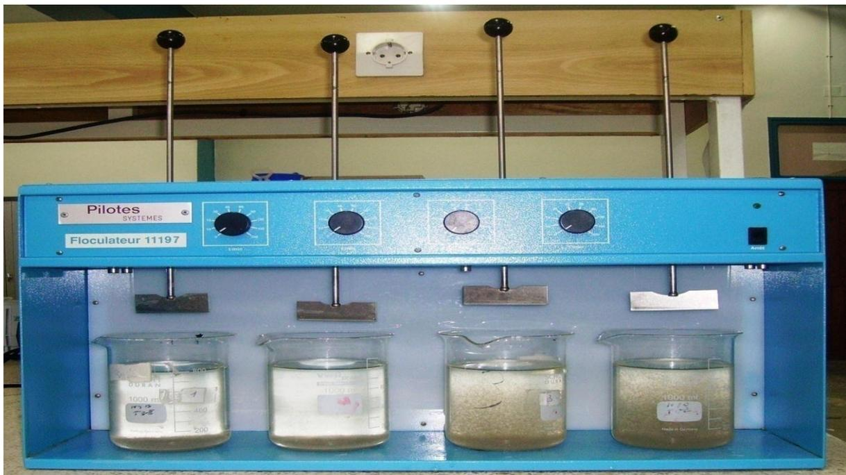
**Figure IV.1 : Jar-Test (floculateur 11197).**
