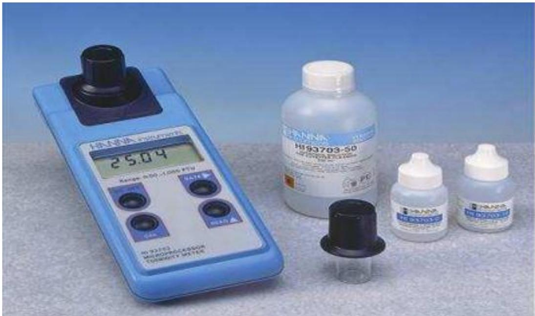
**Figure IV.2 : Turbidimètre.**
