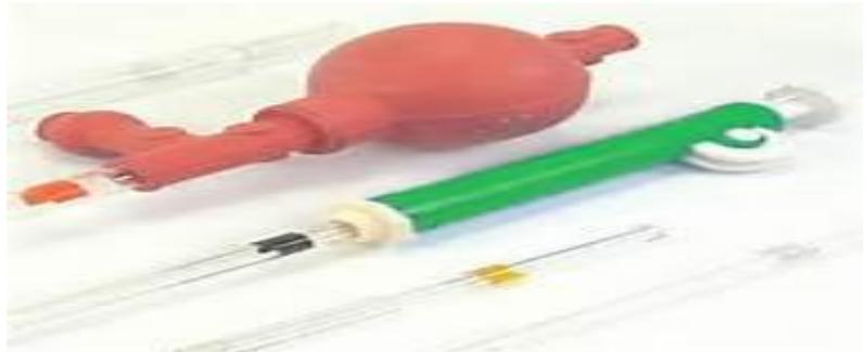
Figure IV.4 : Pipettes utilisé.
