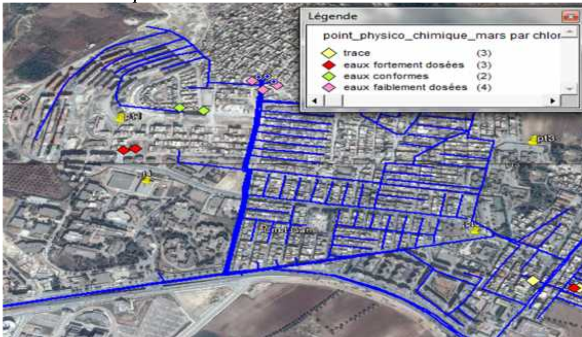
Figure 13: Analyse thématique de la qualité de l'eau dans le réseau d'AEP du chef lieu Chetouane selon le paramètre chlore du mois de mars 2016.
