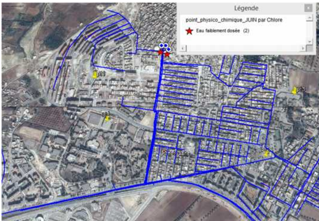
Figure 32: Analyse thématique de la qualité de l'eau dans le réseau d'AEP du chef lieu Chetouane selon le paramètre chlore du mois de juin 2016
