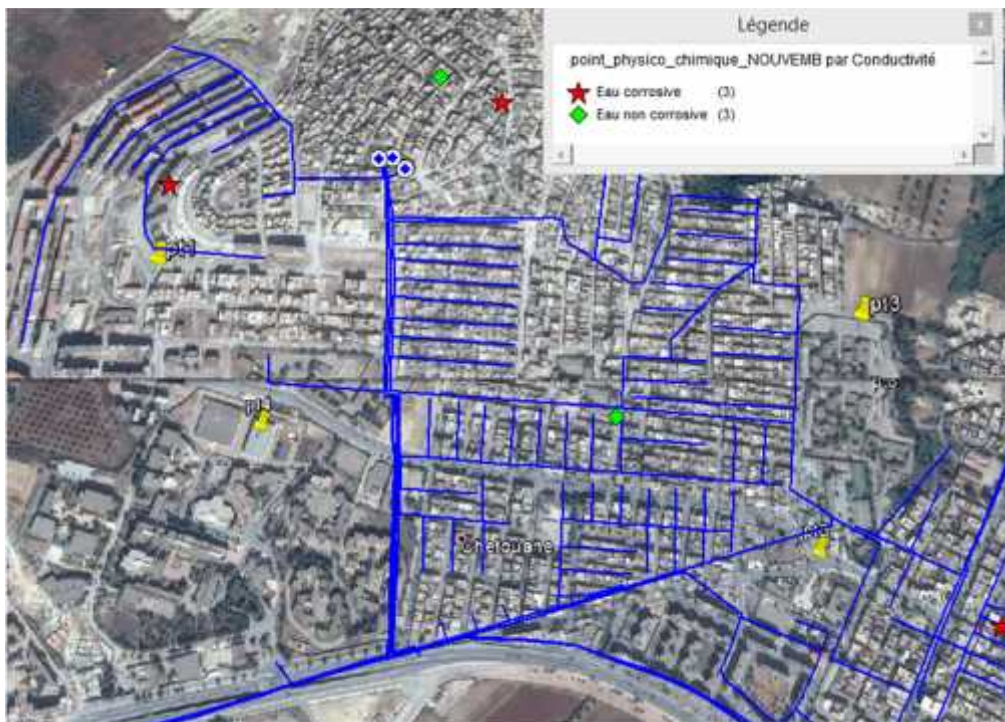
Figure 40: Analyse thématique de la qualité de l'eau dans le réseau d'AEP du chef lieu Chetouane selon le paramètre conductivité du mois de novembre 2016.
