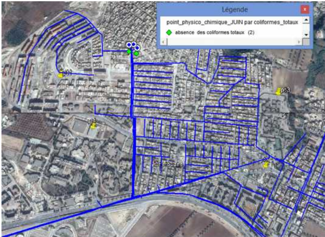
Figure 27: Analyse thématique de la qualité de l'eau dans le réseau d'AEP du chef lieu Chetouane selon le paramètre microbiologique coliformes totaux du mois de juin 2016.
