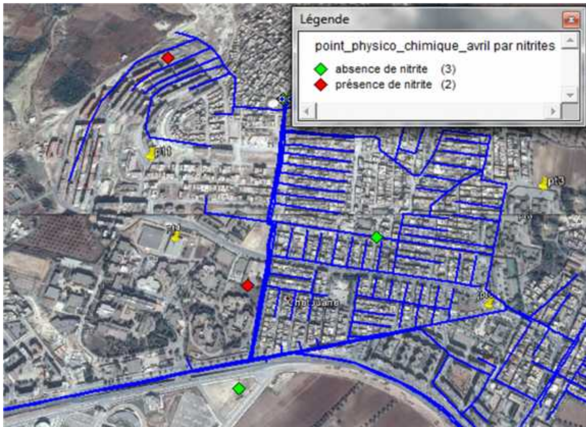
Figure 18: Analyse thématique de la qualité de l'eau dans le réseau d'AEP du chef lieu Chetouane selon le paramètre nitrite du mois d'Avril 2016
