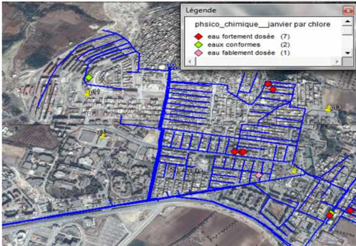
Figure 6: Analyse thématique de la qualité de l'eau dans le réseau d'AEP du chef lieu Chetouane selon le paramètre chlore du mois de Janvier 2016
