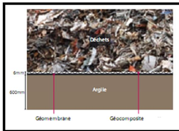
Figure 2.14 stockage de déchets avec le revêtement géocomposite. (Terram ; 2008)
