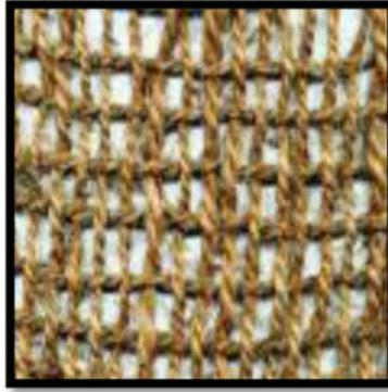
Figure 2.4 Géotextile tricoté
