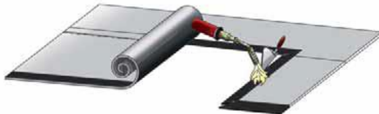
Figure 4.14. About de lé de feuille auto protégée granulés minéraux
