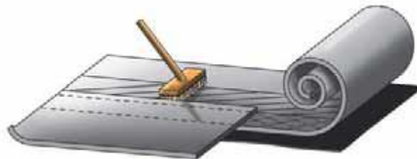
Figure 4.11. : Mise en œuvre par collage de feuilles auto protégées par granulés minéraux
