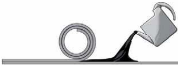
Figure 4.10. : Collage au bitume chaud (EAC) des feuilles bitumineuses
