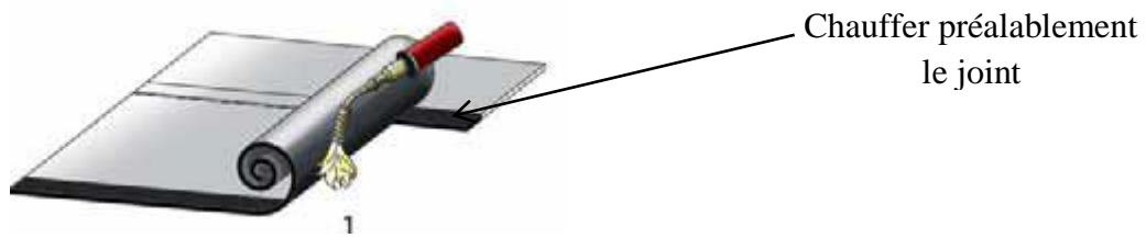
Figure 4.13. Soudage au chalumeau
