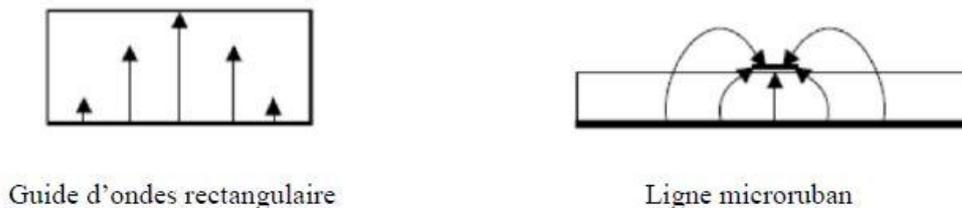
**Figure II.25:** Lignes de champs dans un guide d'ondes rectangulaire et dans une ligne Micro-ruban
