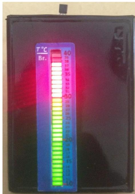
**Figure III.12** : Thermomètre visuel à bargraph
