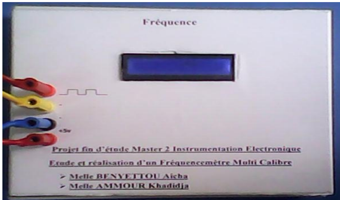
Figure15: photo de fréquencemètre réalisé en boitier.
