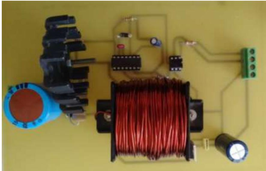
Figure III. 12 :Circuit pratique contient l'hacheur+optocoupleur+driver
