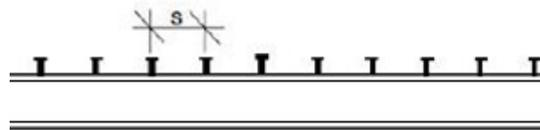
**Figure V.5:** Disposition des connecteurs.
