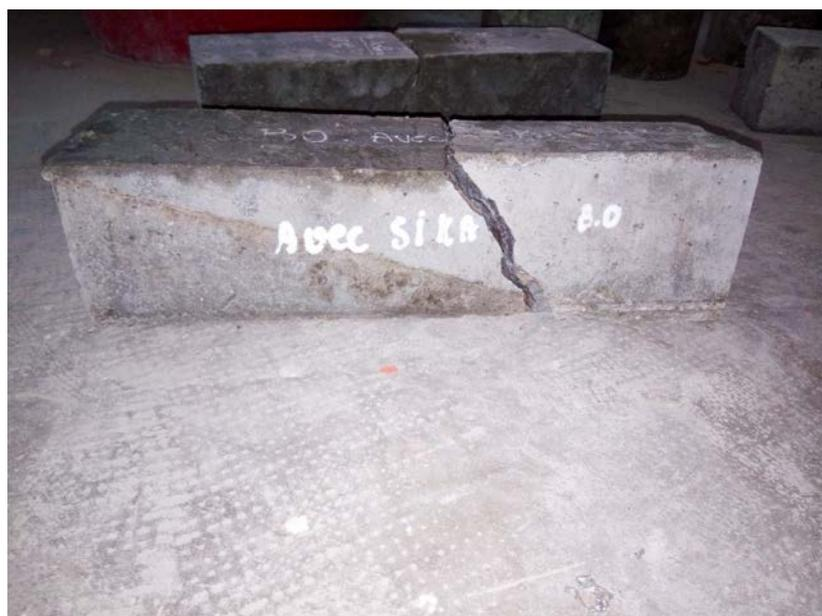
**Figure IV.34: B.O avec une surface inclinée avec Sika.**
