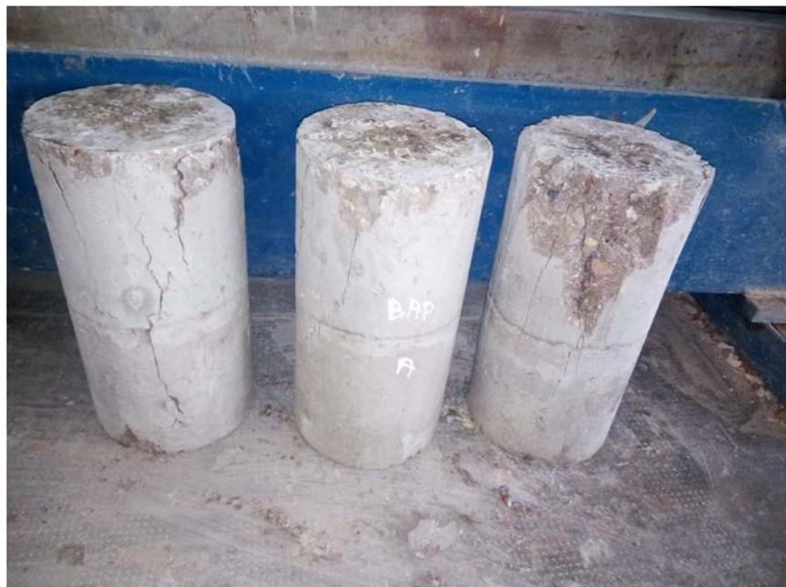
**Figure IV.27: BAP avec une surface horizontale avec Sika.**
