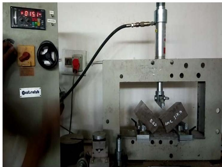
**Figure IV. 40 : essai à la flexion (après).**
