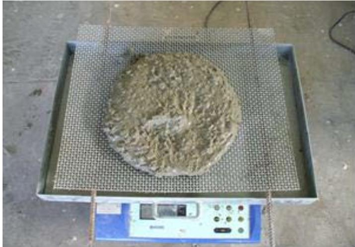
**Figure IV.12: L'essai de stabilité au tamis.**
