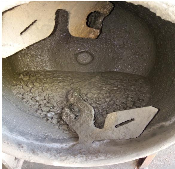
**Figure IV.1 :Préparation de béton ordinaire**
