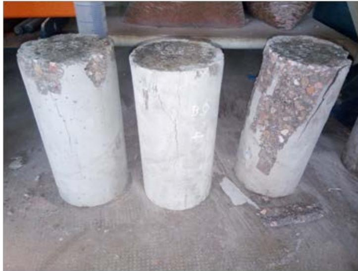
**Figure IV.18: résultats de compression de B.O des éprouvettes coulée avec une inclinaison avec Sika.**
