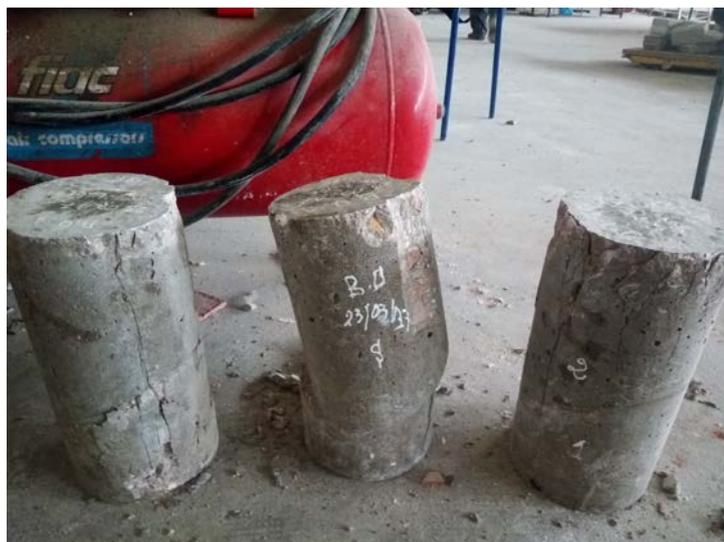
**Figure IV.16: résultats de compression de B.O des éprouvettes coulées avec une certaine inclinaison sans Sika.**
