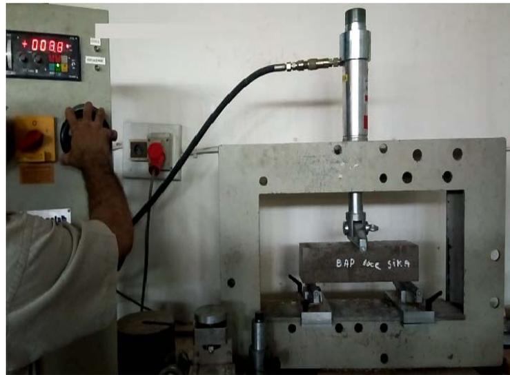
**Figure IV.39 : essai à la flexion (avant).**
