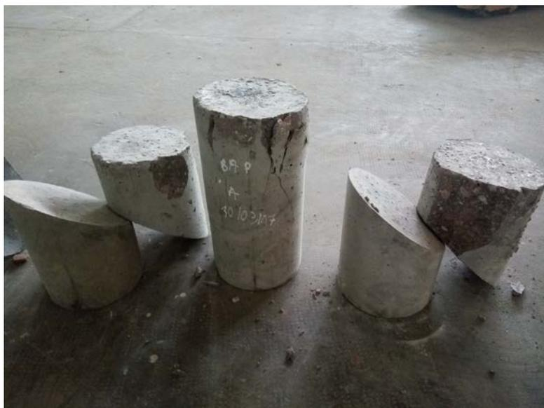
**Figure IV.28: BAP avec une surface inclinée avec Sika.**
