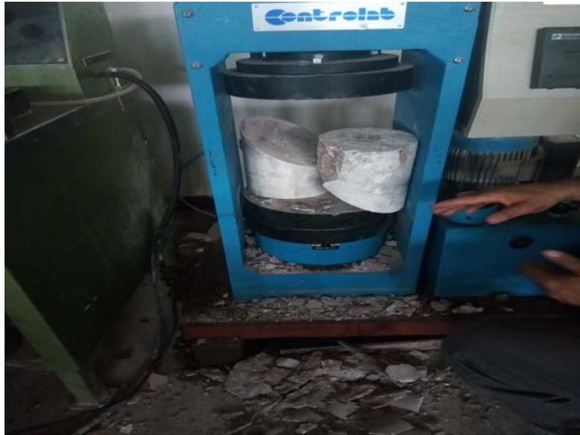
**Figure IV.30 : essai de compression.**
