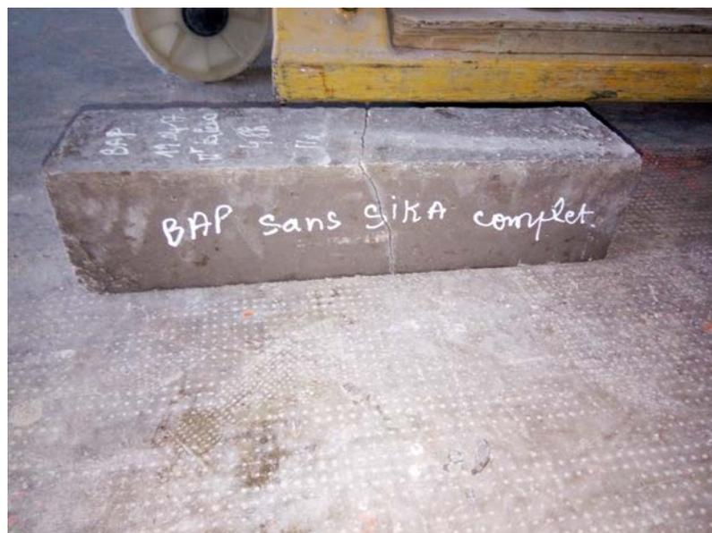
**Figure IV.35: BAP sans reprise de bétonnage.**
