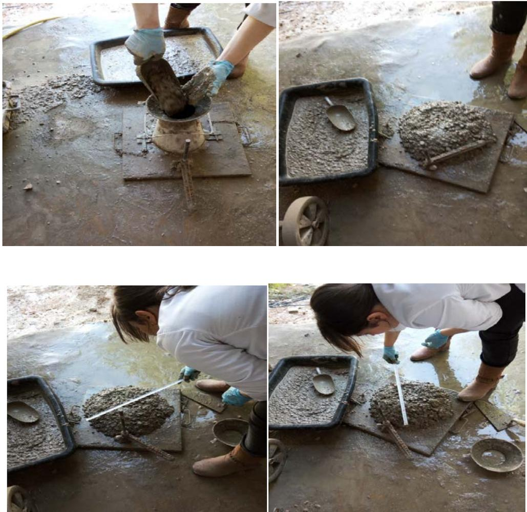
**Figure IV.10: Essai d'étalement au cône d'abrams pour BAP.**
