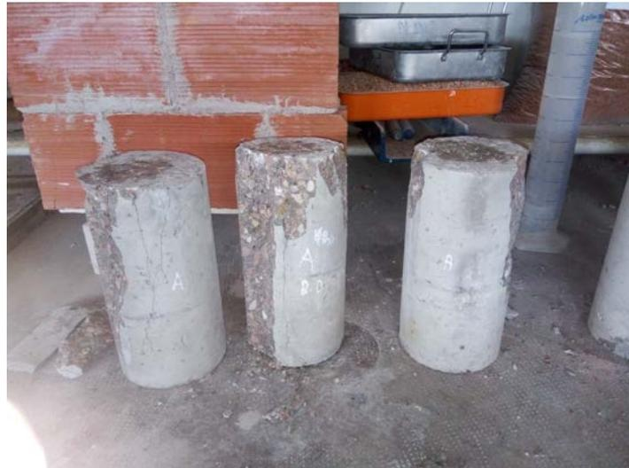
**Figure IV.20 : résultats de compression de B.O des éprouvettes coulées horizontalement avec Sika.**
