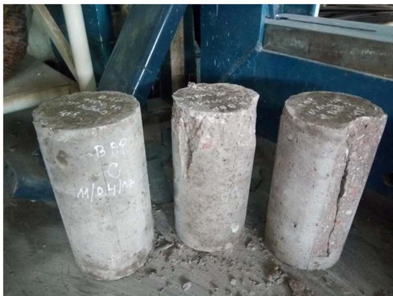
**Figure IV.29: BAP sans reprise de bétonnage.**
