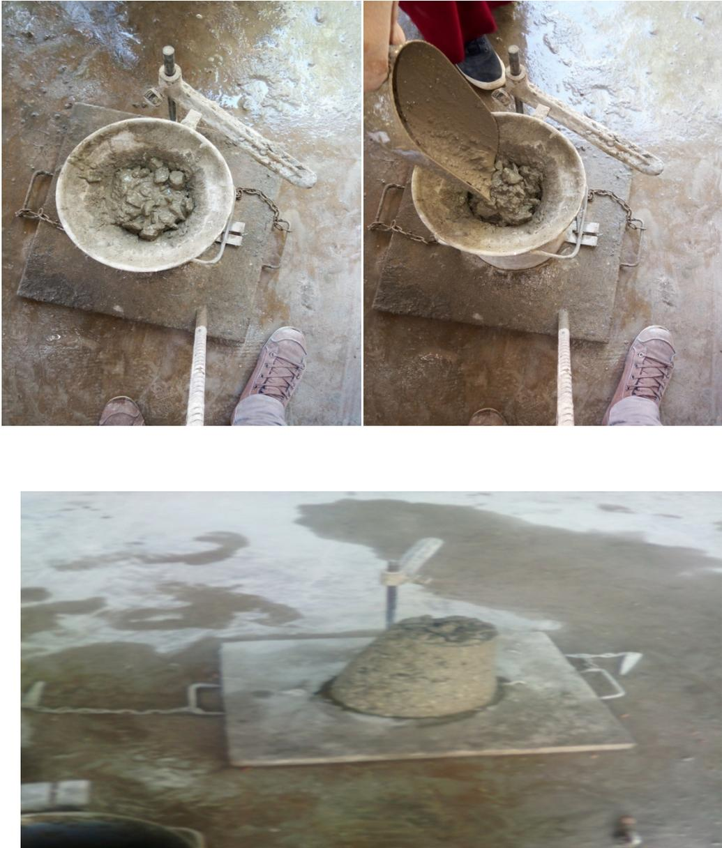
**Figure IV.9: Essai d'affaissement au cône d'abrams.**
