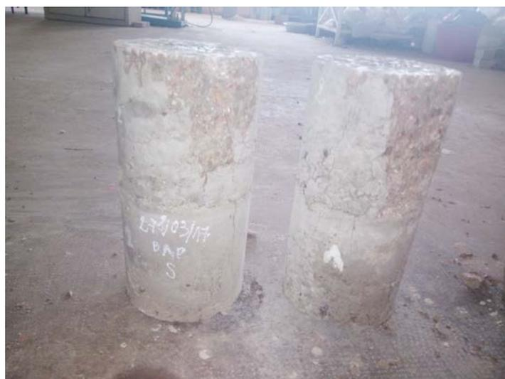
**Figure IV.23 : résultats de compression de BAP des éprouvettes coulées horizontalement sans Sika**
