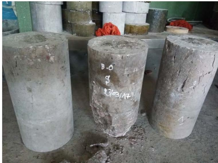
**Figure IV.17: résultats de compression de B.O des éprouvettes coulées horizontalement sans Sika.**
