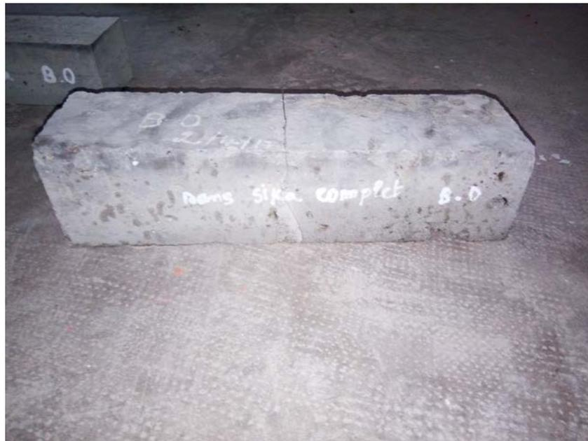
**Figure IV.32: B.O sans reprise de bétonnage.**
