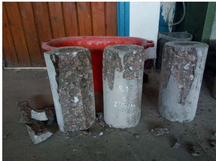
**Figure IV.19: résultats de compression de B.O des éprouvettes coulées complètement.**
