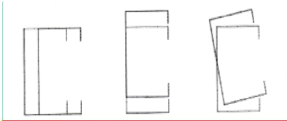
Figure (2.6) : Instabilité globale d'une section en C2 Uniformément comprimée
