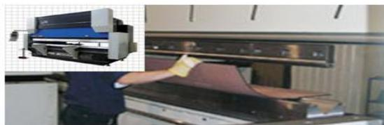
Figure (2.3) : pliage d'une tôle
