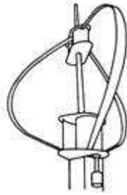
Figure2-8. Schéma du rotor de Darrieus[11]
