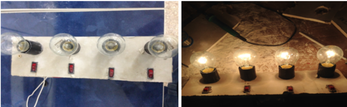
Figure III.17 : Charge purement résistive formée par 04 lampes de 75w.
