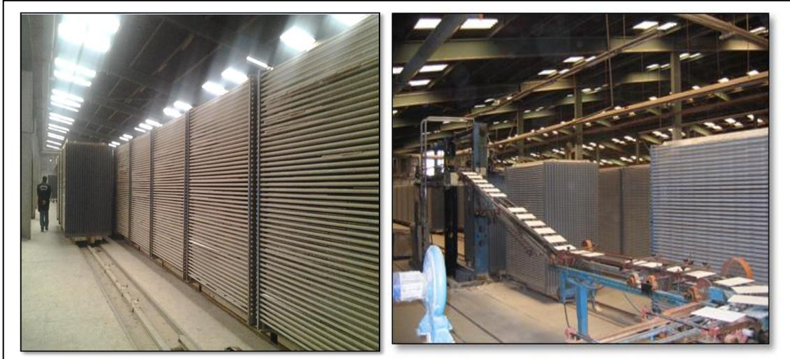
**Figure II.17 :** Stockage de biscuit émaillé dans des boîtes.
