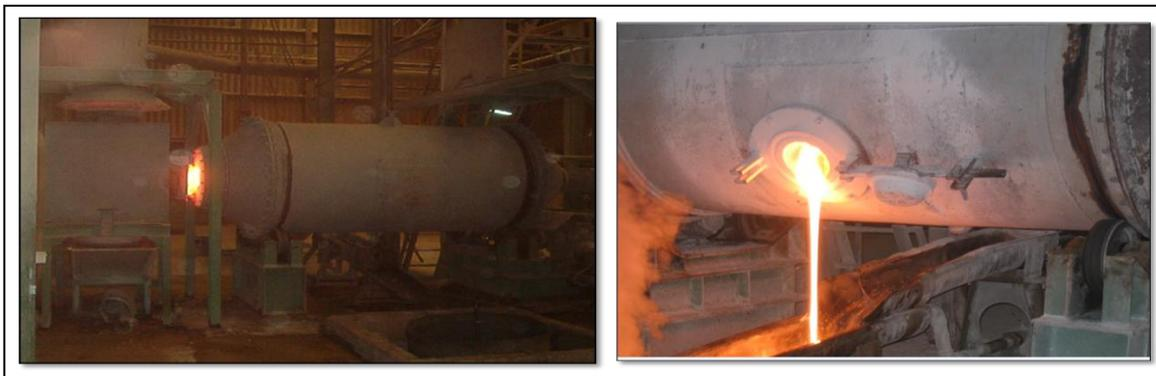
Figure II.9 : Le processus de fusion des frites.
