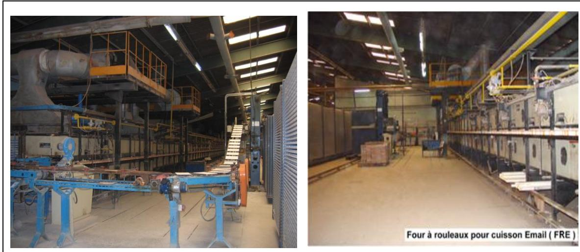
**Figure II.18 :** Le déchargement des box et cuisson des carreaux émaillés.
