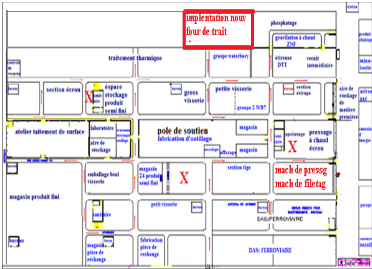
Figure III.8: l'implantation des nouvelles machines. [10]
