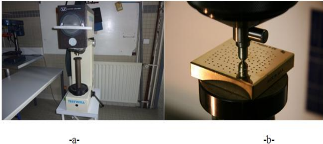
Figure I.18 : a.b. La machine de l'essai de dureté. [6]
