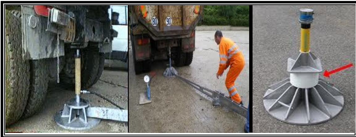
Figure 4.10 : Les essais de plaque.
