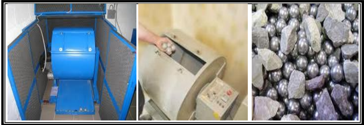
Figure 4.8 : essai los Angeles.
