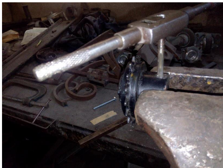
Figure 4.10 : Photo du pignon pendant son taraudage
