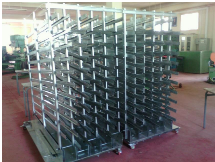
Figure 4.1 : Photo du rack après le montage final
