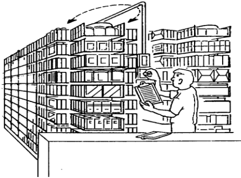
Figure 1.11 : AS/RS à carrousel
