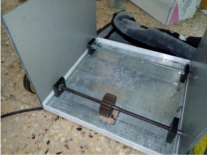
Figure 4.6 : Photo du pignon arbré entrainant le mouvement
