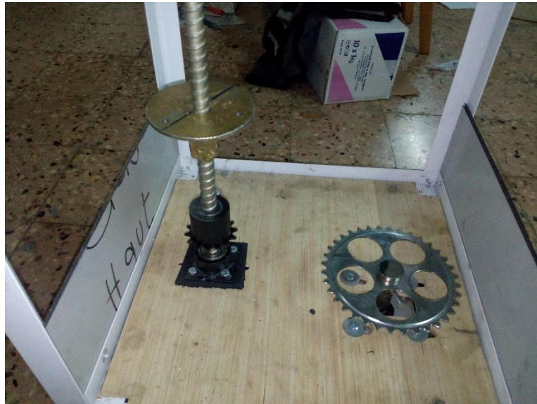
Figure 4.9 : Photo du système de transmission entre le moteur et la tige
