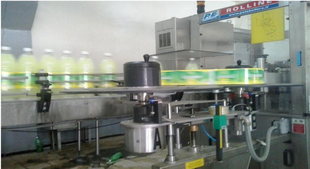
**Fig. II.14. Photo d'une étiqueteuse**
