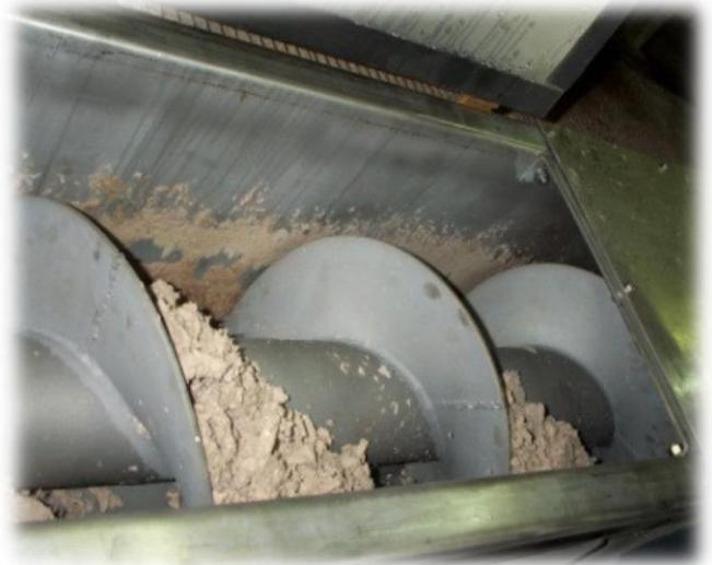
**Figure III.6 : Convoyeur à vis**
