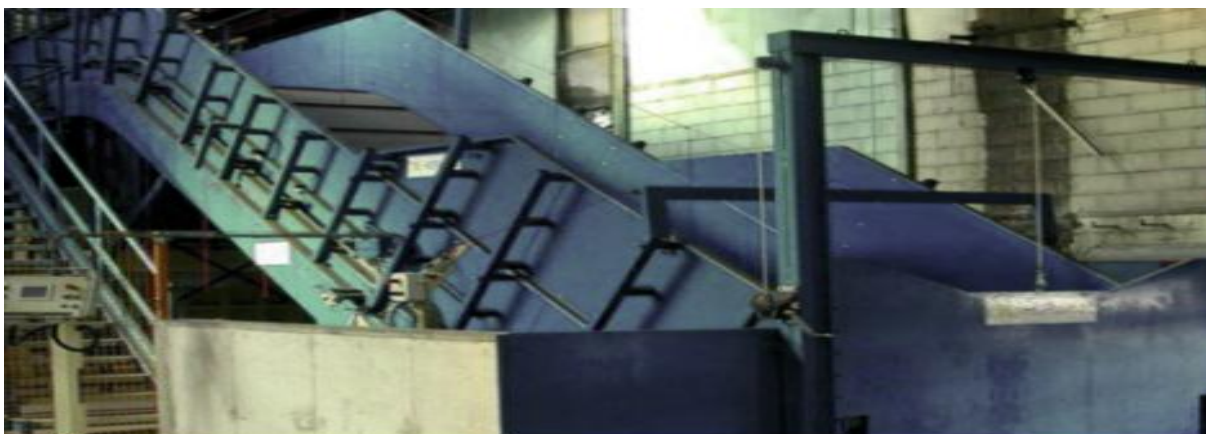
Figure III-14 : tapis d'alimentation de la presse à balles
