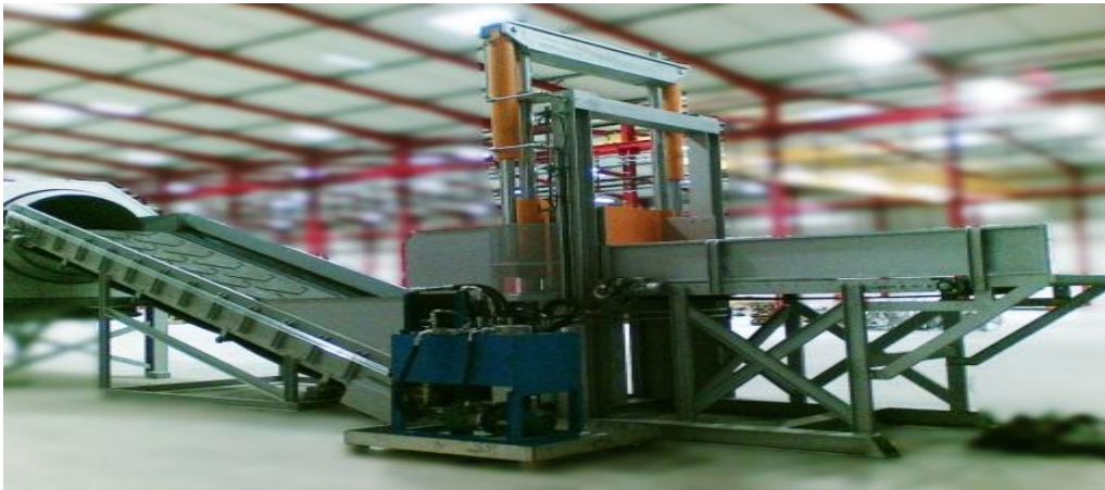
FigureIII.25 : Guillotines (Séparation des matériaux)
