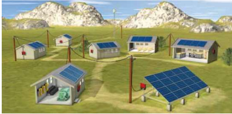
Figure II.12 : Micro-réseau associé à un petit champ photovoltaïque
